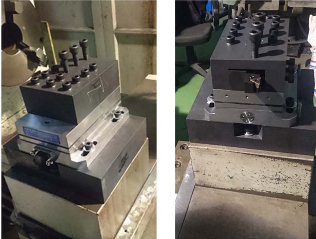
Hình 5.1.2 Bộ đồ gá dao có gắn cảm biến đo lực
