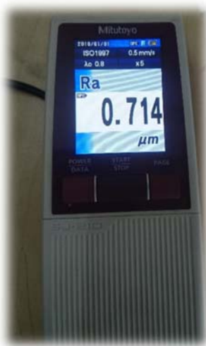
Hình 5.2.5 Kết quả độ nhám hiển thị trên thiết bị khi đo với tiêu chuẩn ISO 1997
