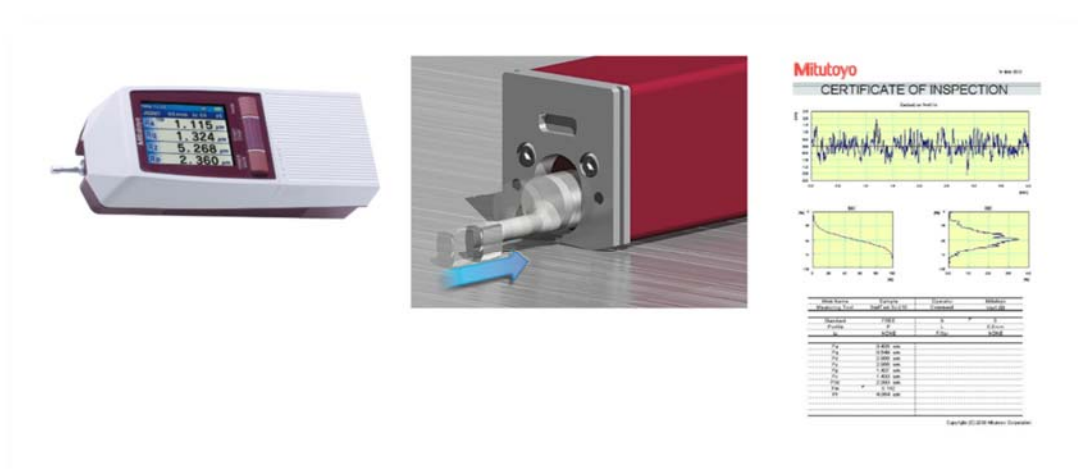
Hình 5.1.6 Hệ thống đo độ nhám bề mặt MITUTOYO SJ-210 178-390 [40]
