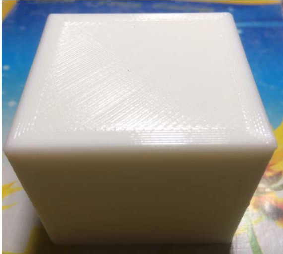
Hình 4.23: Chi tiết hoàn thiện khi sử dụng nhựa PLA để in
