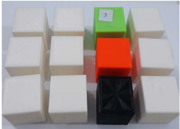
Hình 2.7: Mẫu thí nghiệm sau khi in
