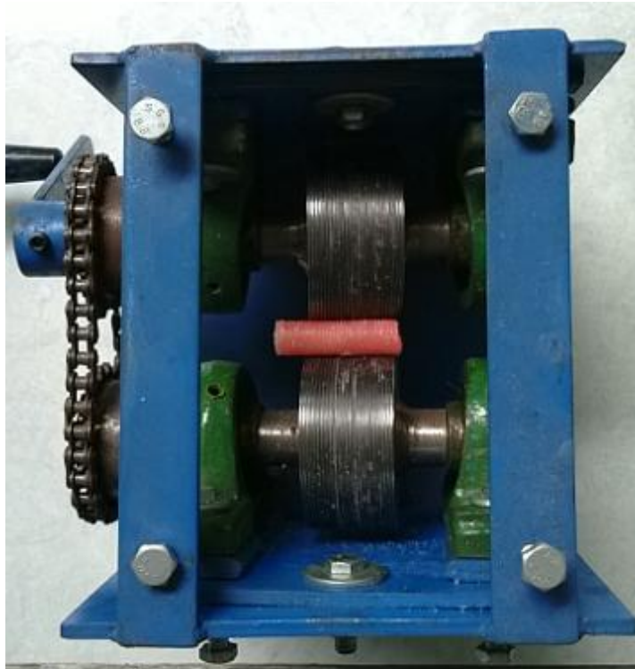
Hình 2.9: Mô hình cán ren vít vô tận bằng con lăn hút vòng
