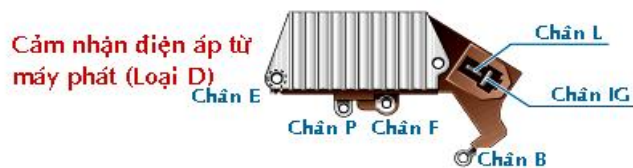
Hình 7: Đầu ra trên tiết chế vi mạch loại D
