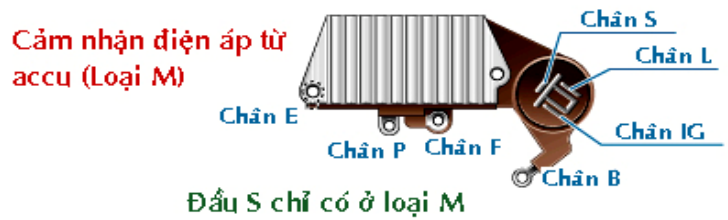
Hình 9: Đầu ra trên tiết chế vi mạch loại M
