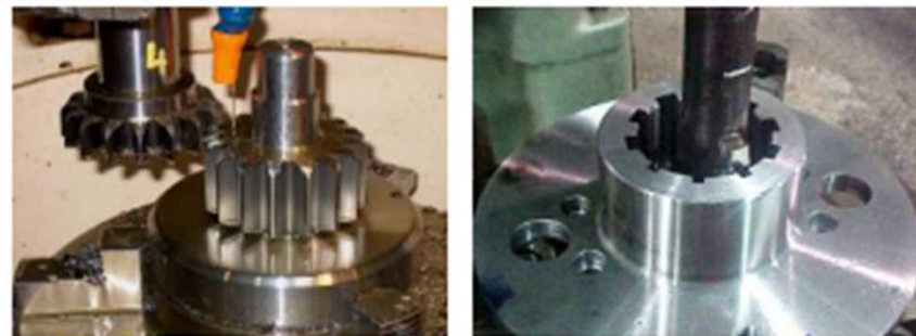
Gia công trên máy xọc
