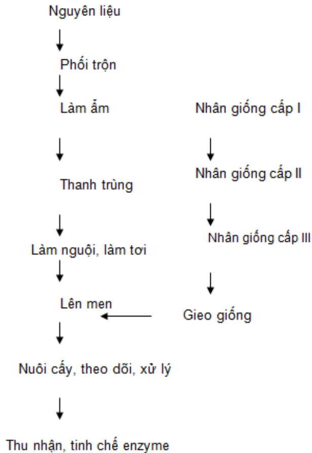
Hình 4.11: Quy trình sản xuất enzyme từ vsv nuôi cấy trên môi trường đặc
