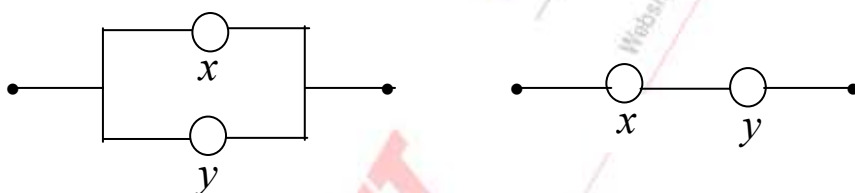
mạng song song cơ bản (hình 1) mạng nối tiếp cơ bản (hình 2)
