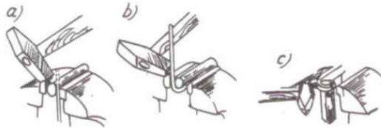
Hình 8.7. Uốn các thanh thép tròn có kích thước lớn trên ê tô
