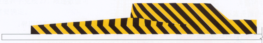
Vạch số 1 - Đường tim trên mặt đường hai làn xe ngược chiều, cm.
