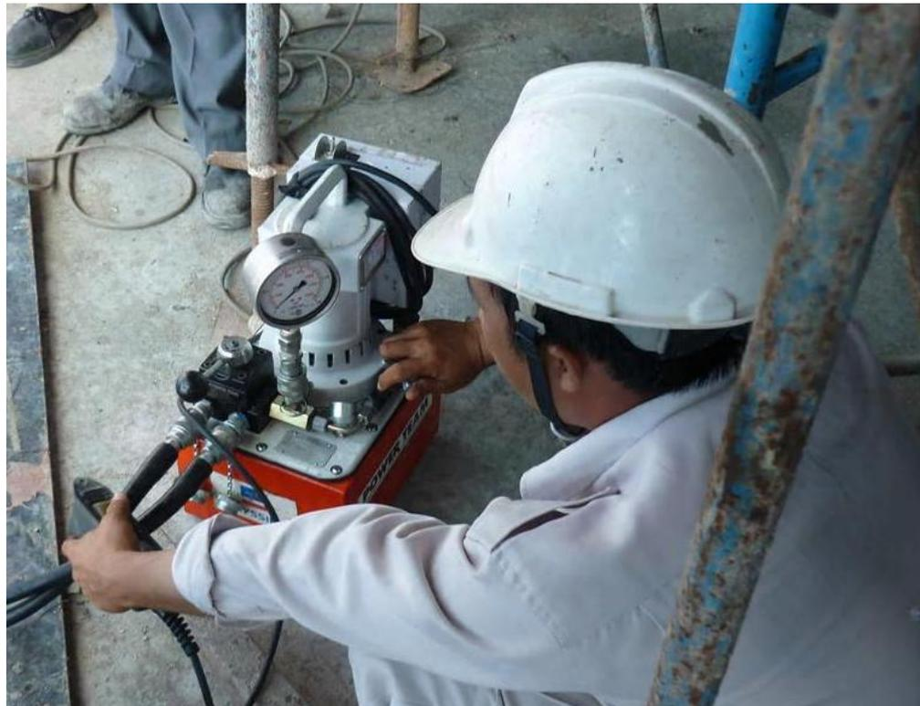
*Hình 2.2. Máy bơm thủy lực và đồng hồ đo áp lực*
